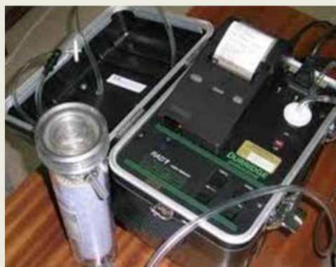
Figura 5 – À esquerda, a imagem do monitor RAD-7 (Durridge Co., Inc.), ao centro a imagem do difusor empregado no método RAD-AQUA para determinação de ^{222}\text{Rn} , através do qual a amostra é aspergida na câmara liberando o gás radônio que é quantificado. À direita, imagem da garrafa empregada no método RAD-Big Bottle, na qual é coletada a amostra e o gás radônio é liberado na porção superior, posteriormente sendo quantificado. Fonte: C. M. da Rocha
