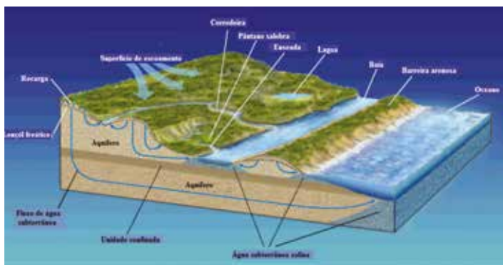
Figura 1 – Ciclo hidrológico, composto pela parcela subterrânea, e a interação entre os compartimentos, adaptado de USGS.
